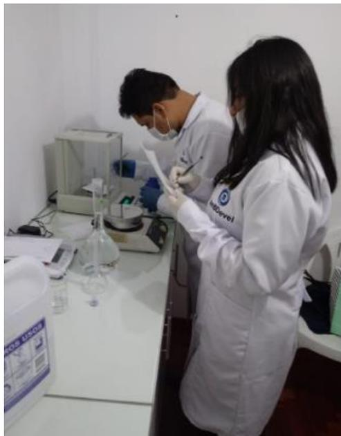
*Figura 20:* Tesistas realizando el pesaje y apunte necesario de los reactivos a usar en la determinación de la concentración de Cianuro Libre.
