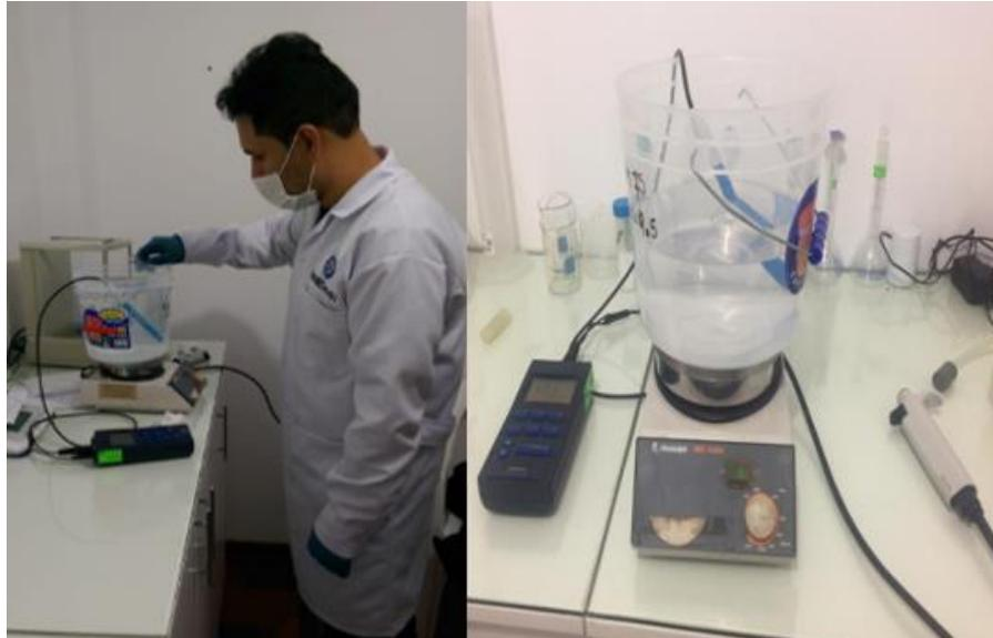
*Figura 19:* Tesista midiendo el pH de las muestras acondicionadas.
