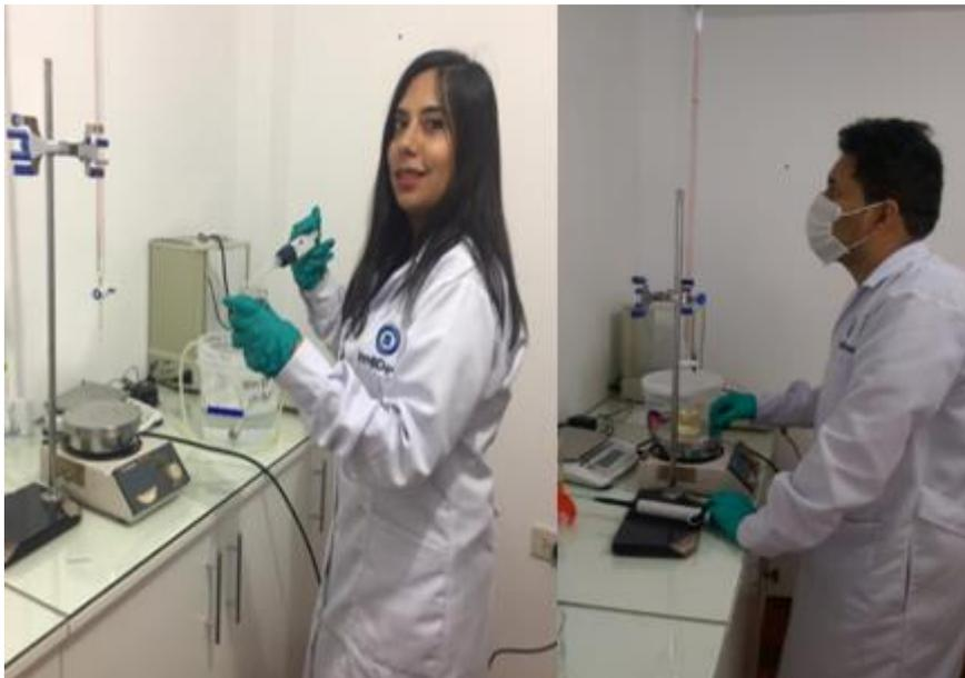
*Figura 22:* Tesistas realizando las pruebas, toma de muestras (izquierda) y titulación (derecha) para la determinación del Cianuro libre.
