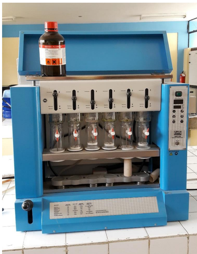
Figura 14: Soxhlet, determinador de grasa cruda
