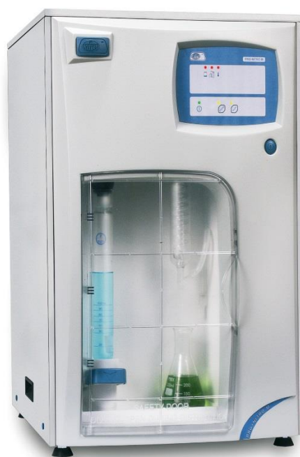
Figura 18: Equipo de neutralización y destilación de proteína DESCRIPCIÓN DE LAS ESPECIFICACIONES TÉCNICAS EN EL ANEXO CORRESPONDIENTE
