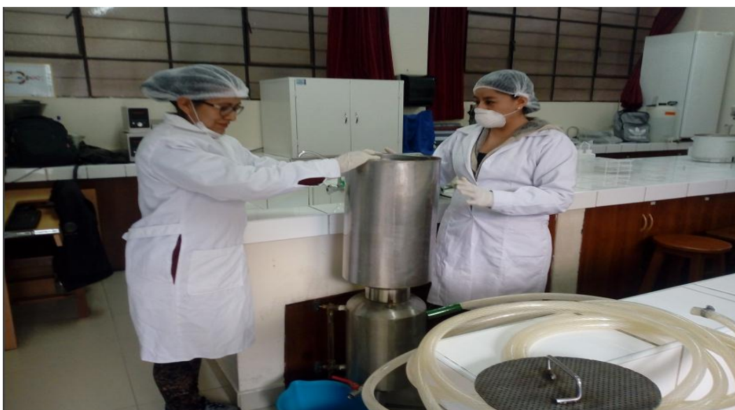
Fotografía N° 02: Equipo de extracción del aceite esencial.
