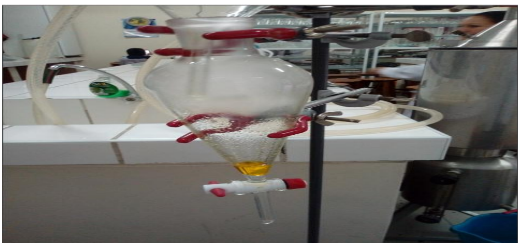
Fotografía N° 05: Obtención del aceite esencial de tomillo.
