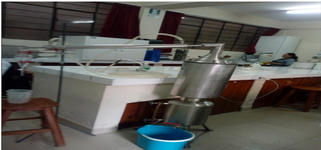
Fotografía N° 03: Extracción de las hojas de tomillo para la obtención del aceite esencial.
