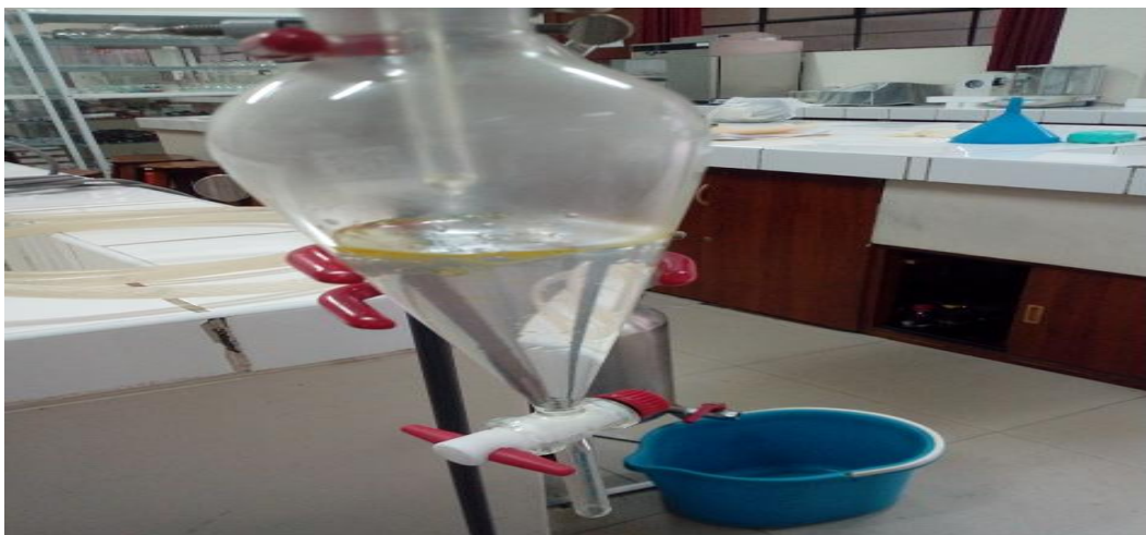
Fotografía N° 04: Decantación del aceite esencial de tomillo.
