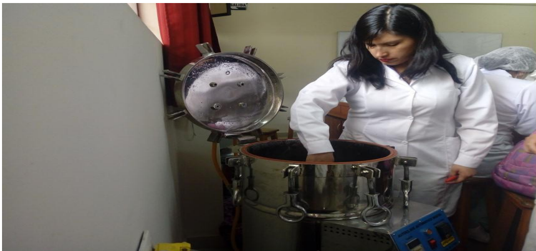
Fotografía N° 07: Medios de cultivo en la autoclave.
