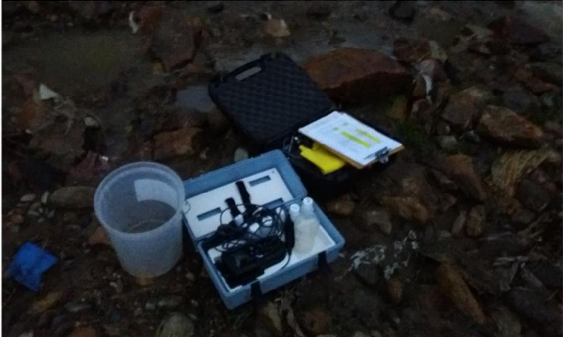
**Imagen 2.** Equipo multiparámetro para la medición in situ de pH.
