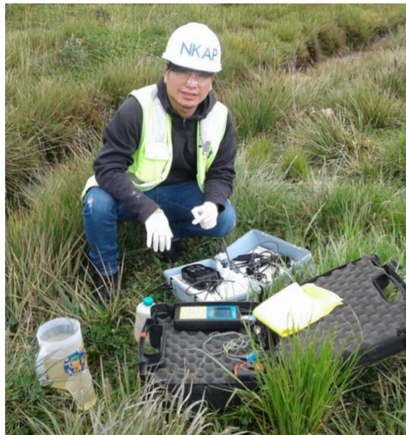
**Imagen 3.** Verificación y ajuste de equipo para medición de pH.
