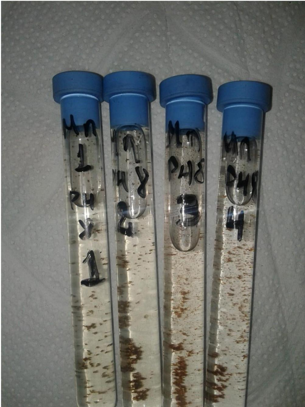
**Imagen 9.** Muestra para lecturas a pH 8 y tiempos de 5, 10, 15 y 20 minutos, monitoreadas a la salida del circuito de ozonización.
