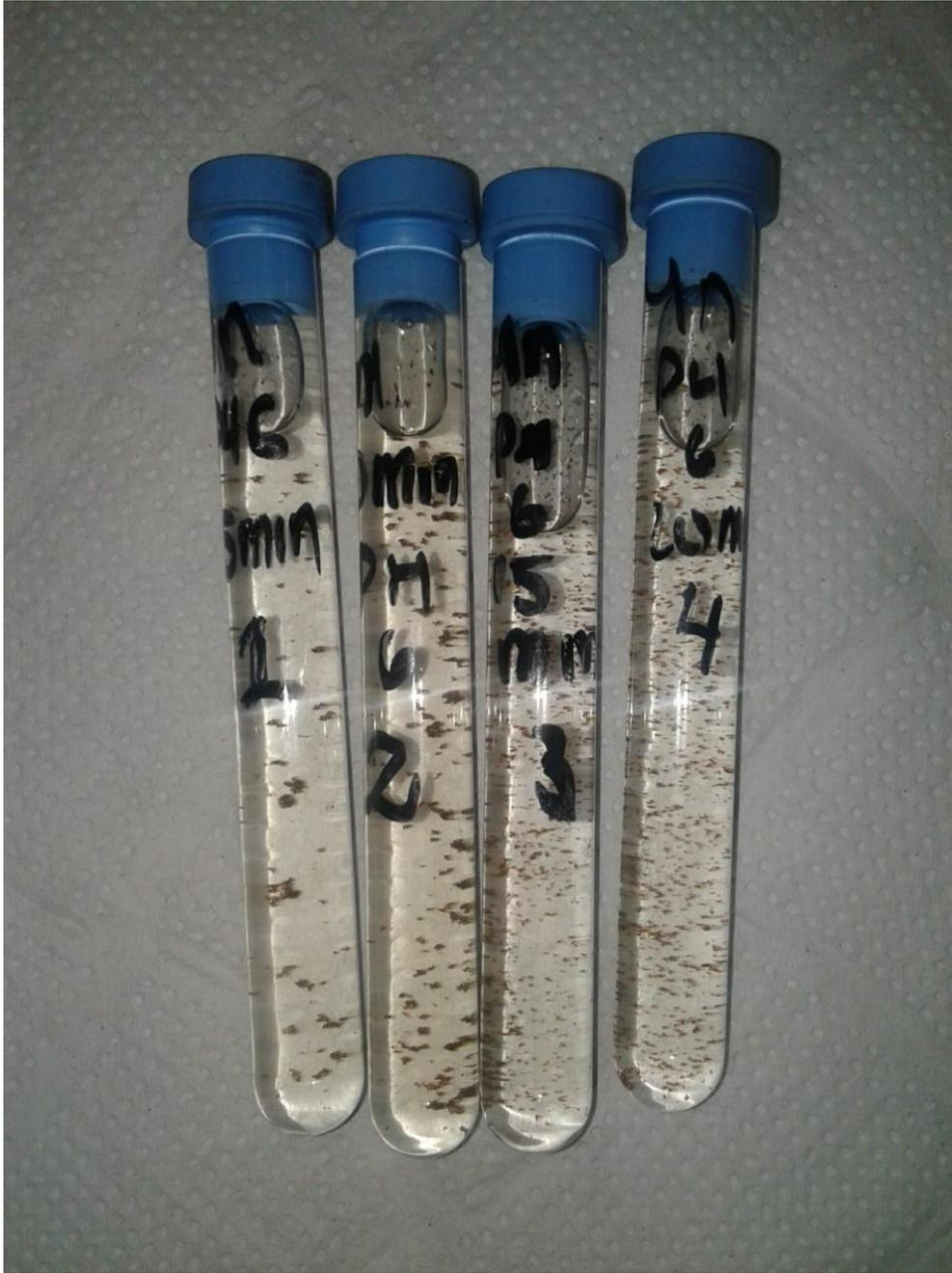
**Imagen 7.** Muestra para lecturas a pH 6 y tiempos de 5, 10, 15 y 20 minutos, monitoreadas a la salida del circuito de ozonización.
