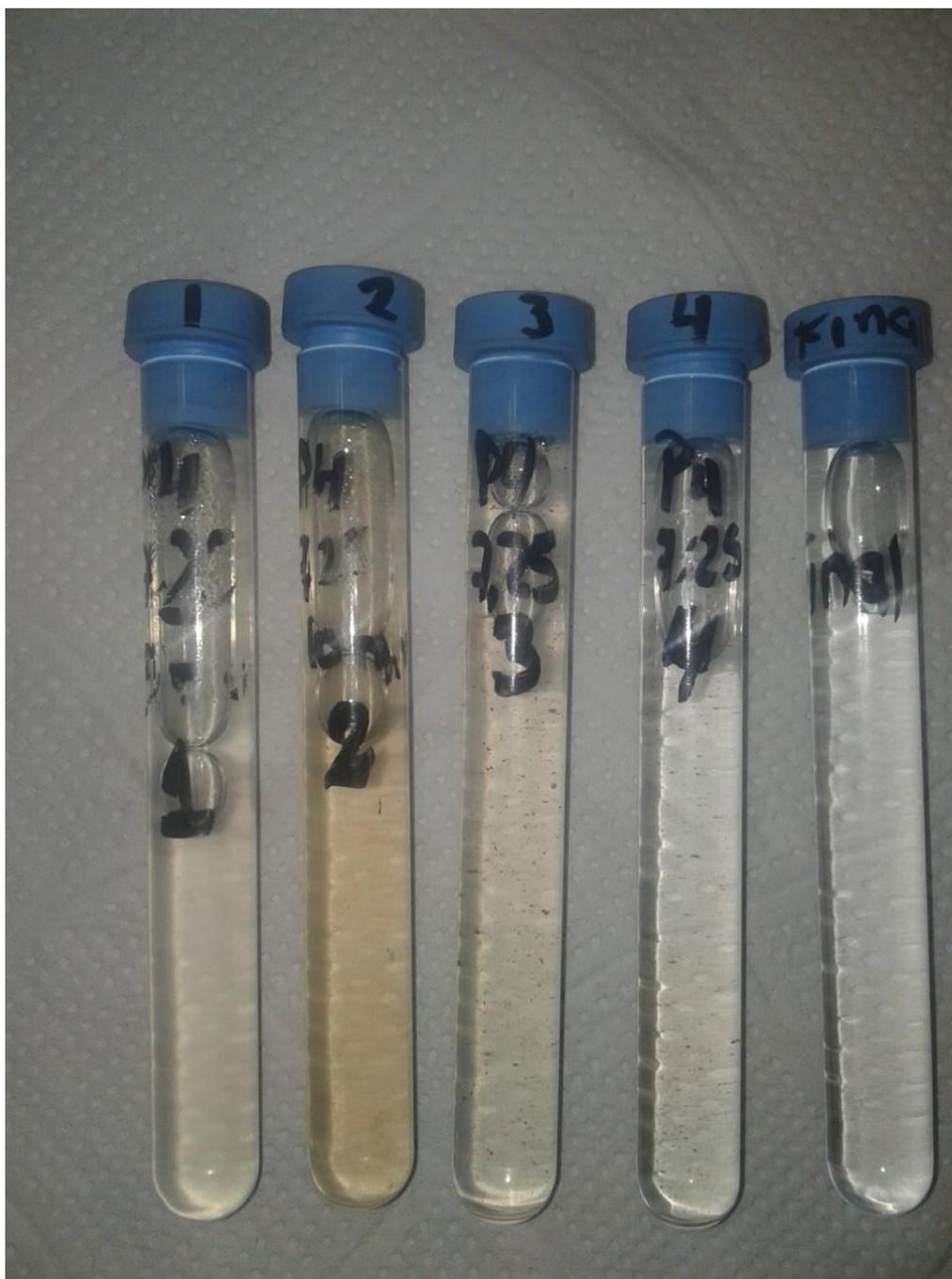
**Imagen 8.** Muestra para lecturas a pH 7 y tiempos de 5, 10, 15 y 20 minutos, monitoreadas a la salida del circuito de ozonización.
