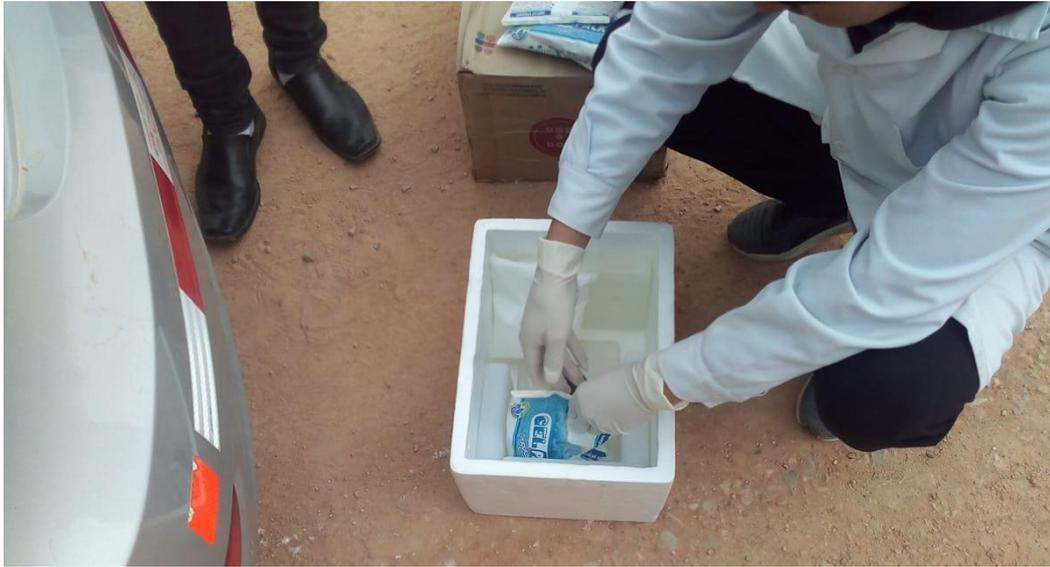
Transporte y almacenamiento de las muestras de agua y suelo en cajas con barras de hielo.
