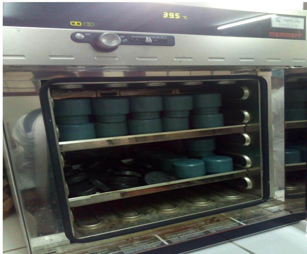
Decontaminación de frascos de polietileno con ácido nítrico al 10% v/v y se seco en estufa a 45°C durante 24 horas.
