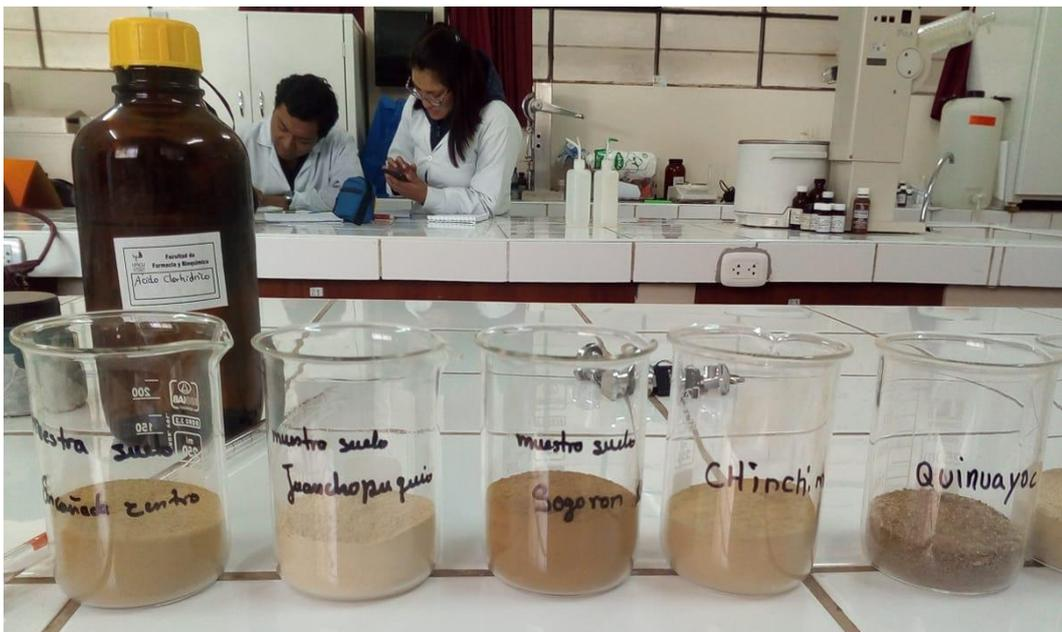
Adición de ácido nítrico más ácido clorhídrico, más ácido bórico a cada muestra de suelo para extraer el arsénico a medio acuoso.
