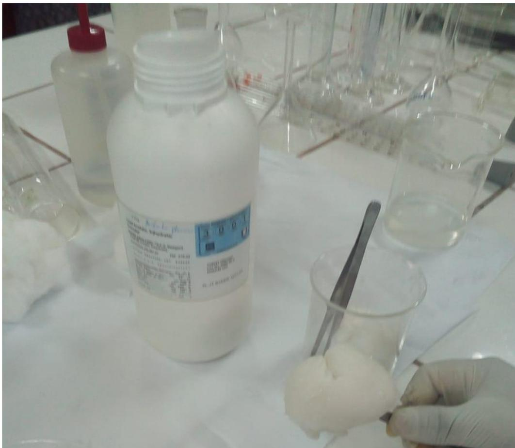
Impregnación del algodón hidrofílico con solución de acetato de plomo
