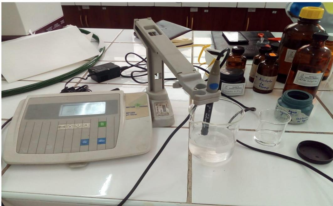
Acidificación de las muestras de agua a  $\text{pH} < 2$  con ácido nítrico.
