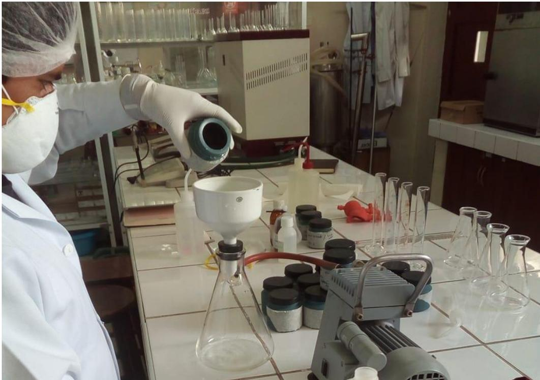
Filtración de las muestras de agua con equipo de bomba al vacío
