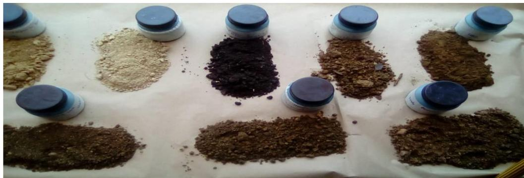
Eliminación de humedad de muestras de suelo sobre papel kraft: secado bajo techo por 24 horas.
