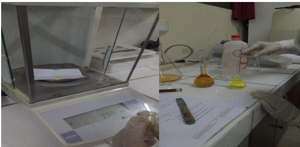
Fotografía N° 10: Cuantificación de flavonoides. Preparación de la solución problema: Pesaje de quercetina y disolución en etanol
