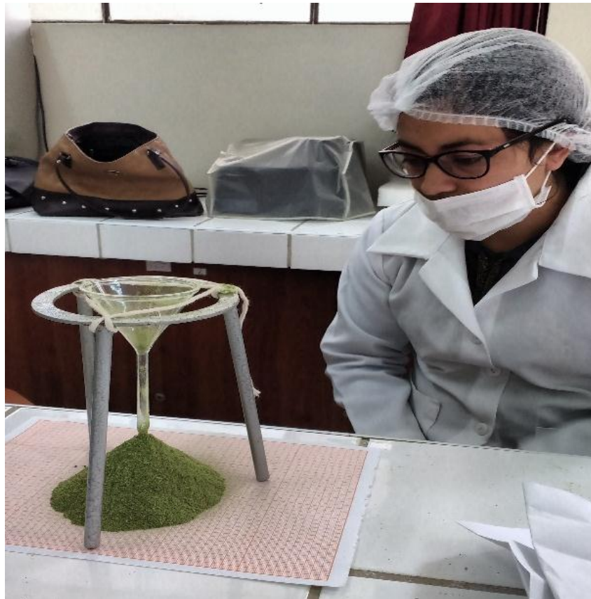
Fotografía N° 15: Determinación de la fluidez mediante ángulo de reposo.
