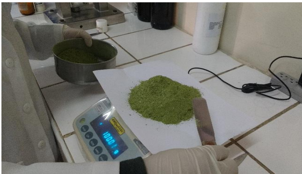
Fotografía N° 13: Pesado de las hojas pulverizadas de Psidium guajava “Guayaba” para el proceso de tamización.
