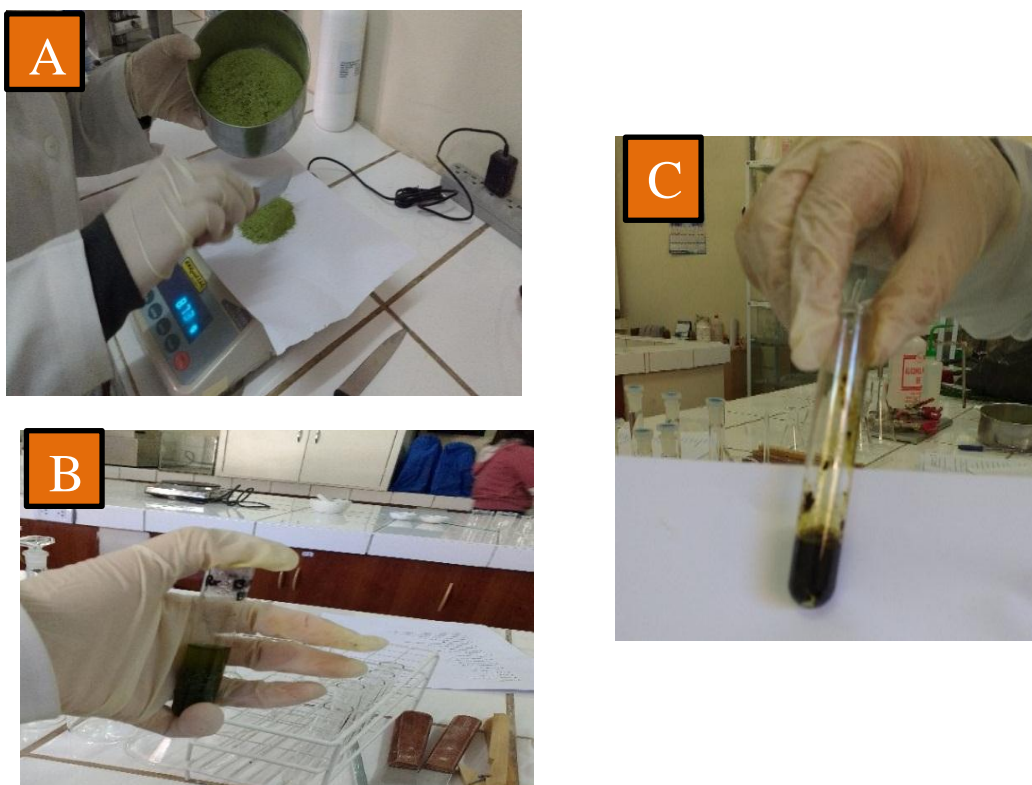
Fotografía N° 06: Identificación de drogas antraquinonas: Reacción de Bornträger: A) pesado de las hojas pulverizadas de Psidium guajava "Guayaba", B) Agitación de la muestra con benceno, C) coloración roja al adicionar gotas de hidróxido de potasio 1%.
