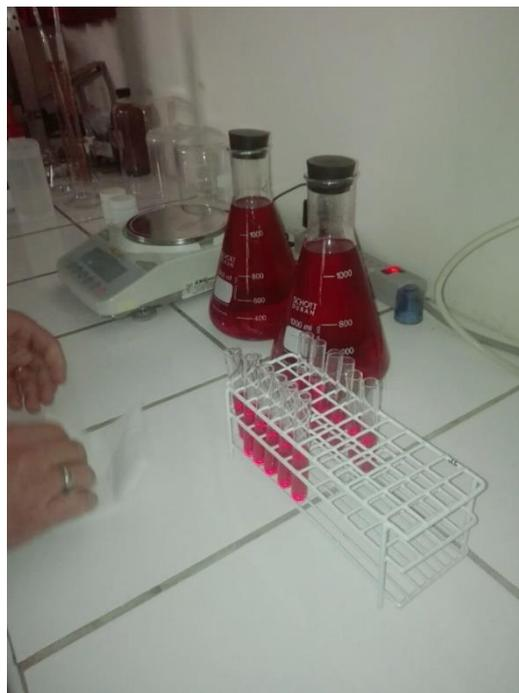
Figura 12. Muestras para colocar en el espectrofotómetro.
