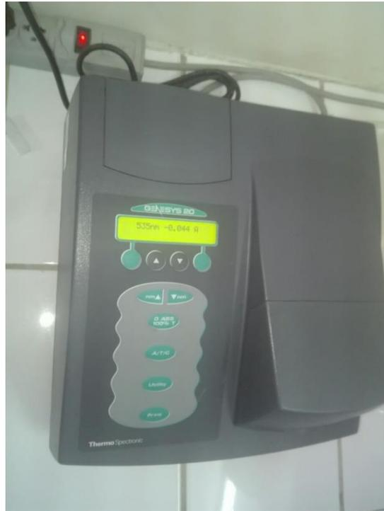
Figura 13. Lectura de la absorbancia en el espectrofotómetro a una longitud de onda de 535 nm.
