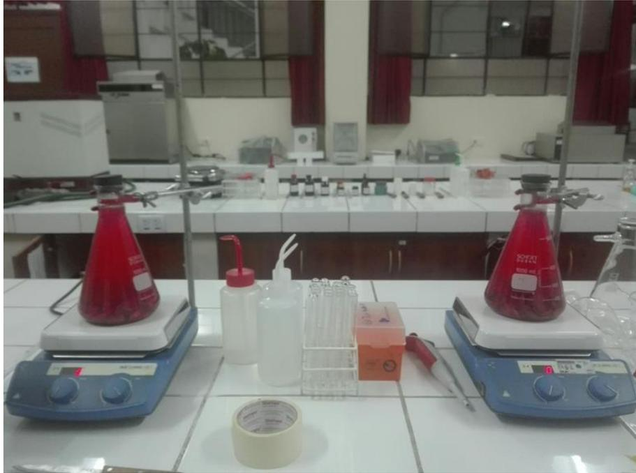
Figura 9. Muestra y solvente en el agitador magnético.
