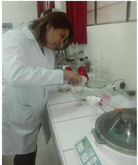
Figura 10. Filtrado de la muestra con papel filtro.
