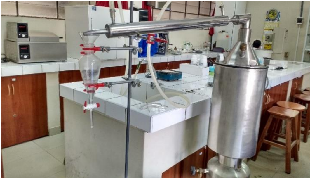
Foto N° 03: Obtención de las hojas de Dodonaea viscosa L. Jacq “Chamana” y Minthostachys mollis (Kunth) Griseb “Muña”, mediante destilación con el destilador de caldera de acero inoxidable.
