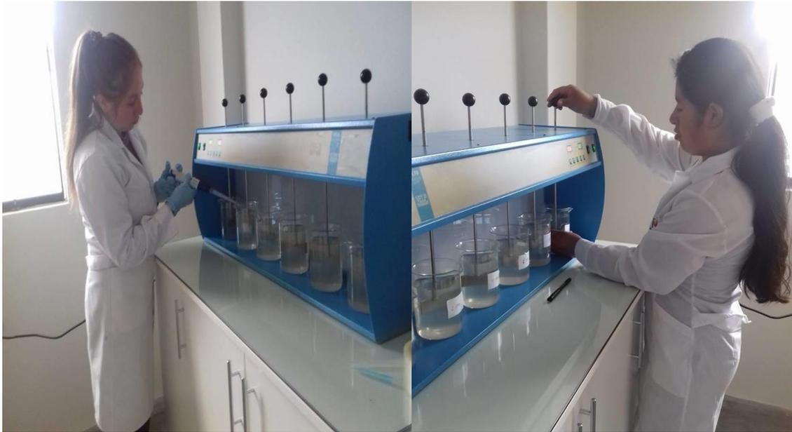
Figura 24. Realización de las pruebas utilizando el tes de jast
