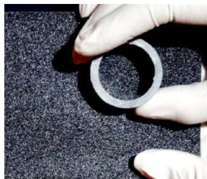
Imagen N° 18: Se obtuvieron 16 tubos de agua 1/2" PBC (Pavco vinduit) de 15 cm. de alto y 33 de ancho.
