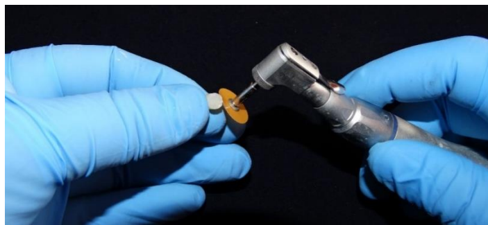
Imagen N° 15: Pulido de los cilindros de resina compuesta con el sistema de discos marca Sof-Lex™-3M grano fino.
