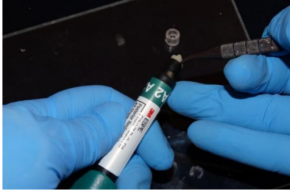
Imagen N° 7: Retiro de la resina compuesta Filtek Bulk Fill (3M-ESPE) con la espátula teflón.
