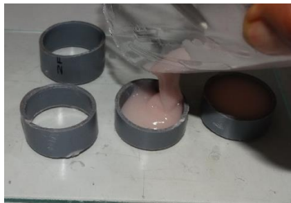
Imagen N° 21: Se realizó el vaciado de acrílico previamente preparado sobre las muestras de tubo teniendo como base una platina de vidrio.
