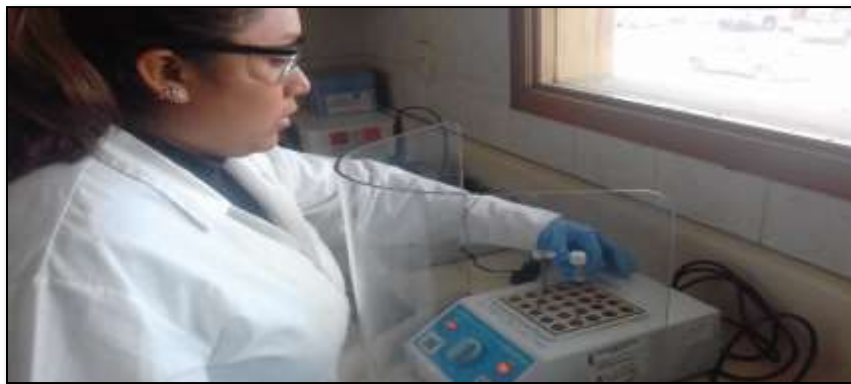
Figura 21: Tubos preparador colocados en el Reactor.
