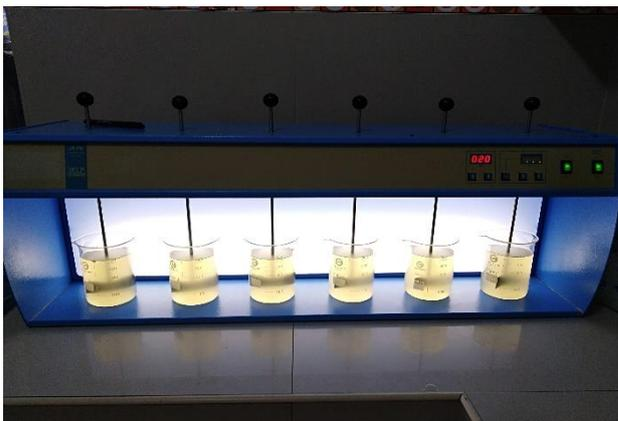
Figura 20. Foto 11 Prueba de test de jarras
