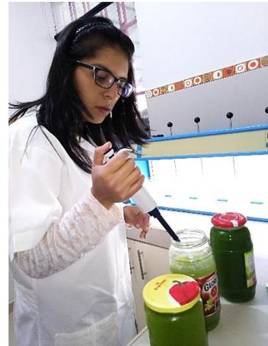
Figura 19. Foto 10 agregando el mucilago a los beaker para la prueba de jarras.
