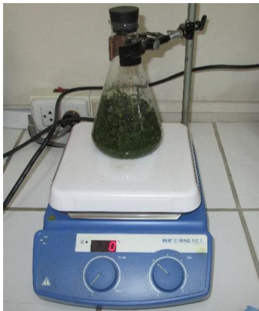
Fotografía 5: Mezcla uniforme con agitador magnético durante 24 horas.
