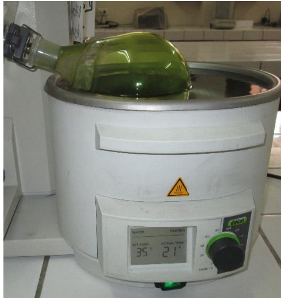
Fotografía 7: Rotaevaporación de la muestra durante 15 minutos.
