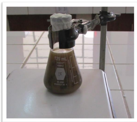
Foto 7. El extracto ya en agitación, fue dejado por 24 horas y se le colocó papel metálico para protegerlo de la luz y evitar la desnaturalización del mismo.
