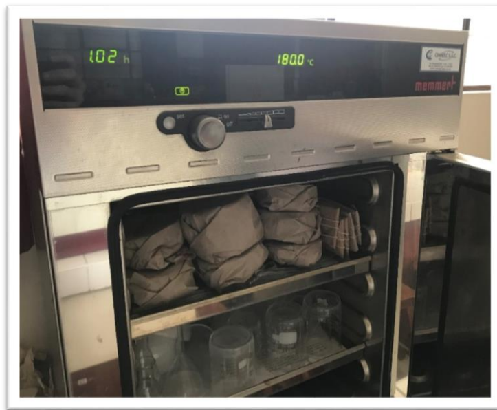
Foto 3. Todo el instrumental a usar en la estufa Memmert® a 180° por 1 hora bajo todos los protocolos de calidad para investigación.
