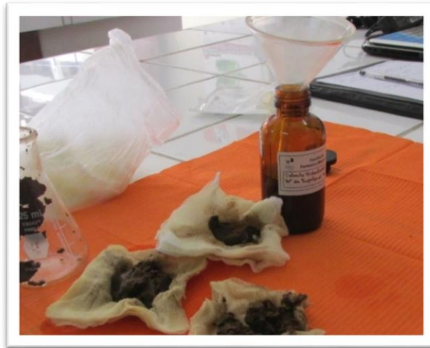
Foto 8. Pasadas 24 horas se procedió a realizar el filtrado, con el embudo y gasas estériles, hacia el frasco color ámbar anteriormente esterilizado.
