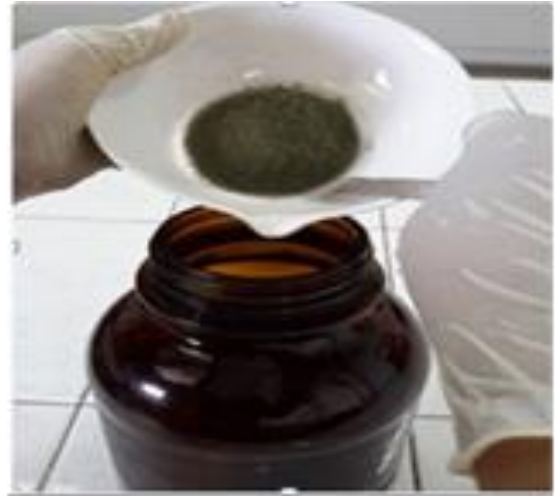
Colocando 30 gr de propóleo en polvo en un frasco más 100 ml. de etanol de 96°, llevando a extraer con agitación a 48 hrs.
