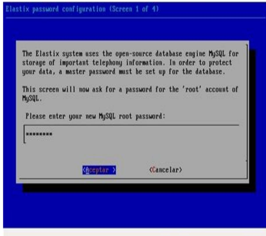
**Figura 28:** Configuración de credenciales de Base de Datos.
