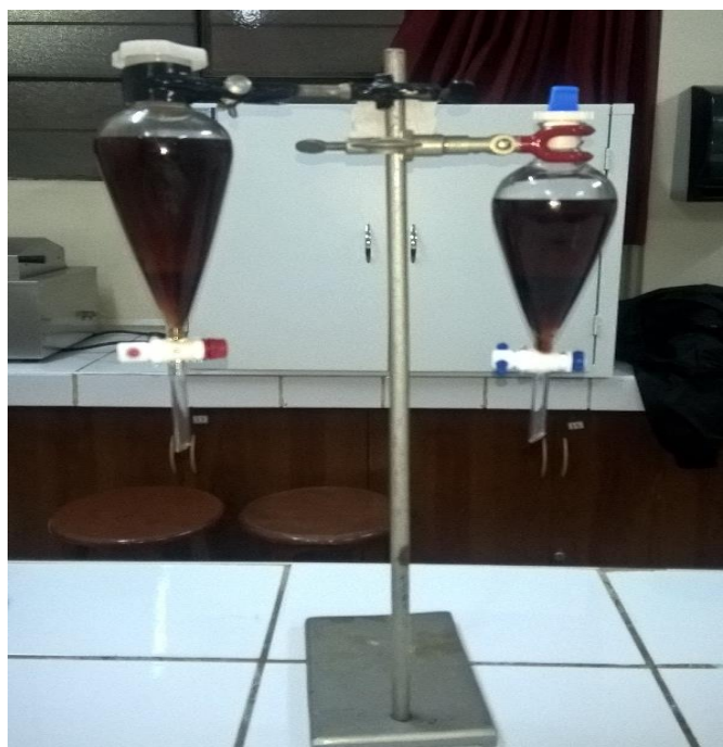
Foto 6. Separación del extracto butanólico después de 24 horas de reposo en una pera de decantación.
