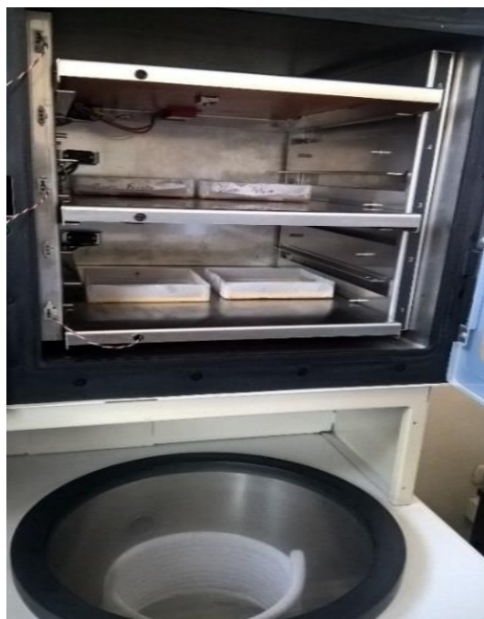
Foto 7. Proceso de liofilización de las saponinas triterpénicas de Sapindus saponaria L.
