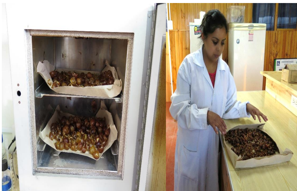
Foto 2. Secado de la pulpa de Sapindus saponaria L., en estufa a 35 °C durante 24 horas.
