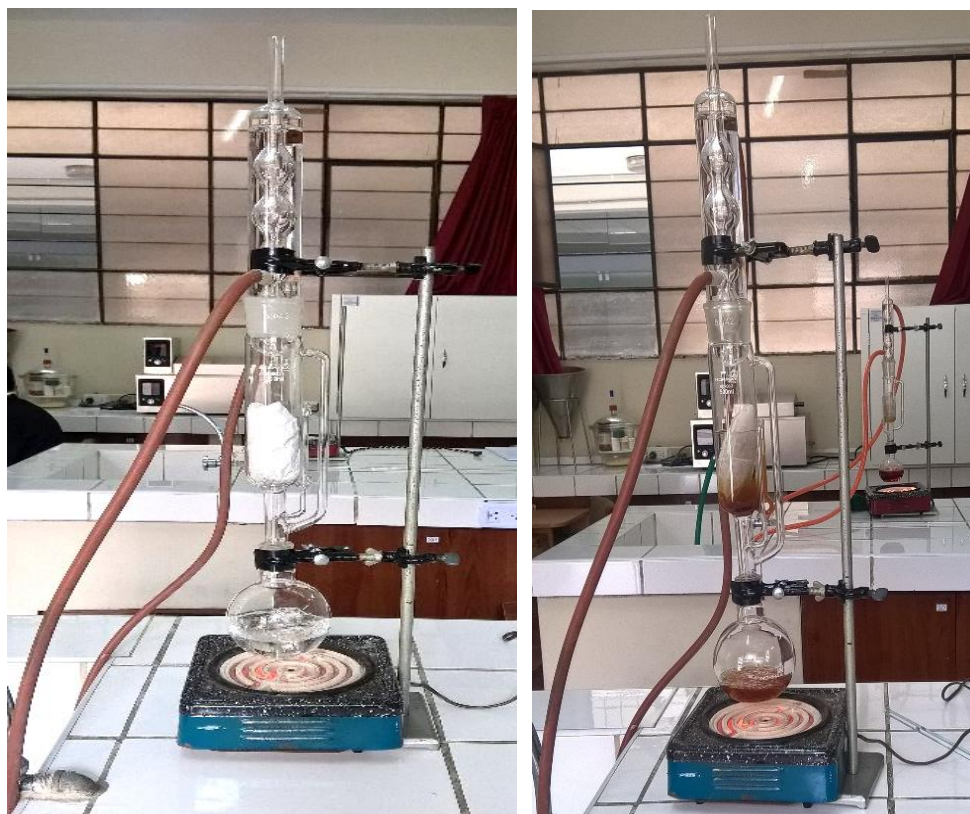
Foto 4. Extracción con Soxhlet hasta el agotamiento de la muestra.
