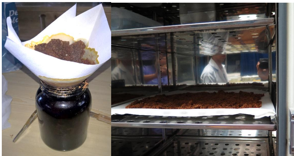
Foto 3. Filtrado y secado de la muestra molida, después de 72 horas de maceración.
