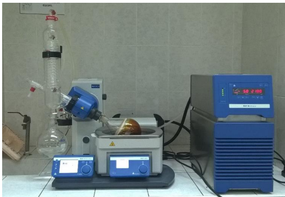
Foto 5. Concentración del extracto etanólico a sequedad en un rotaevaporador.
