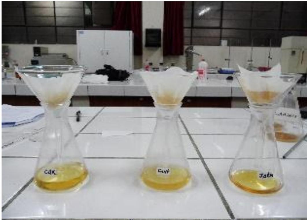
Foto N° 05: Filtración de la muestra pos agitación
