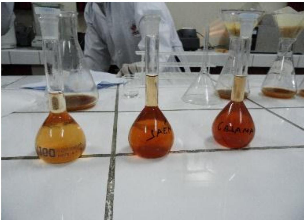
Foto N° 03: Muestras para filtrar con la ayuda de la bomba de vacío
