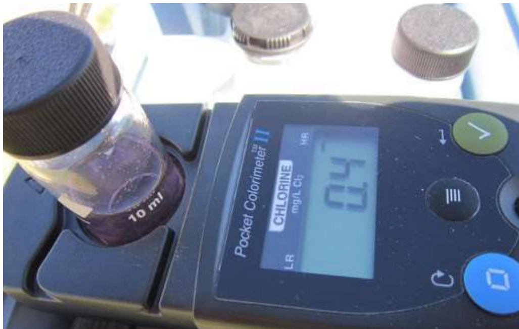
FOTOGRAFIA 02: MEDICION DE CLORO RESIDUAL – CLORIMETRO, EL CUAL TIENE QUE SER MENOR A 0.5
