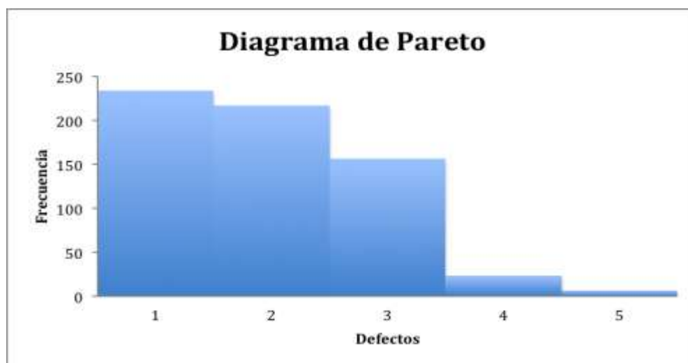
Gráfico 7: Diagrama de Pareto – Frecuencia de fallas en el proceso productivo Elaboración Propia
