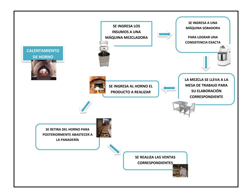
*Nota:* La figura N° 1 muestra el proceso de producción de los tipos de panes a realizar, como primer y principal paso tienen el calentamiento de horno, por aproximadamente 45 minutos.
