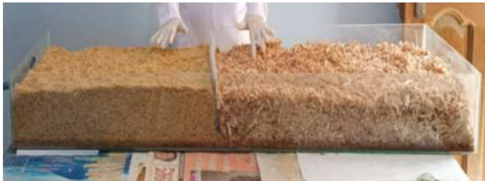
Ilustración 12. Maqueta con capas de filtros
