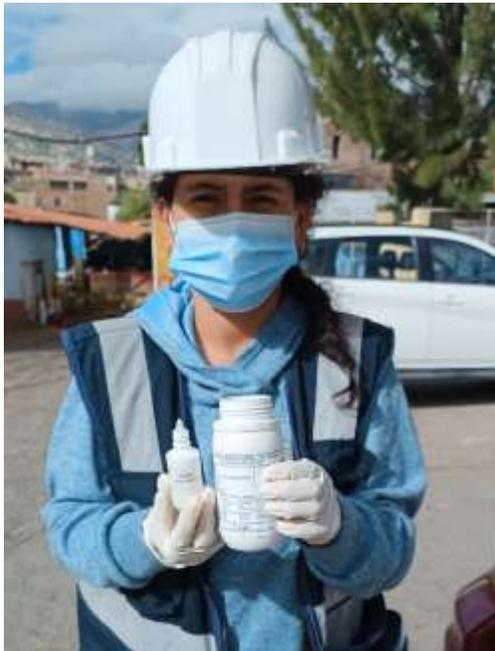
*Ilustración 8. Preservación de la muestra de DBO con 15 gotas de Ácido Sulfúrico.*
