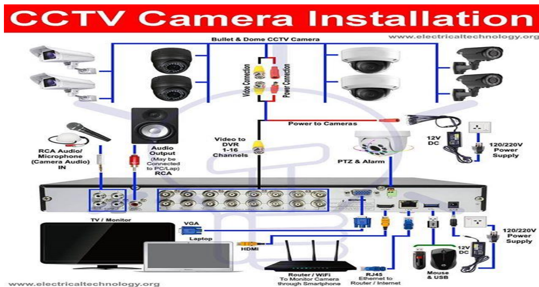
Ilustración 14 Cableado estructurado camaras
