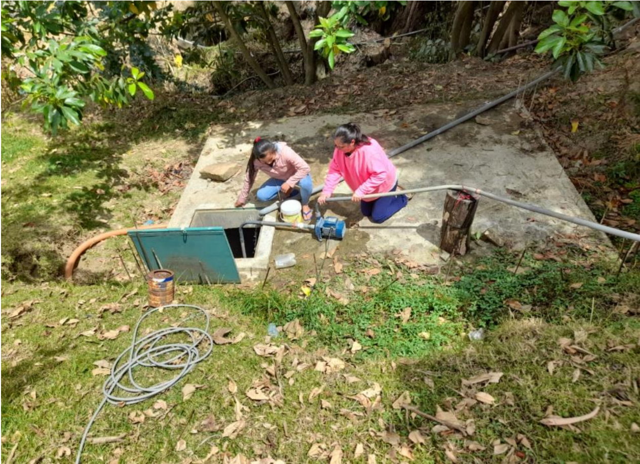
Fotografía 5: Succión de agua con motobomba de cisterna a parcela.
