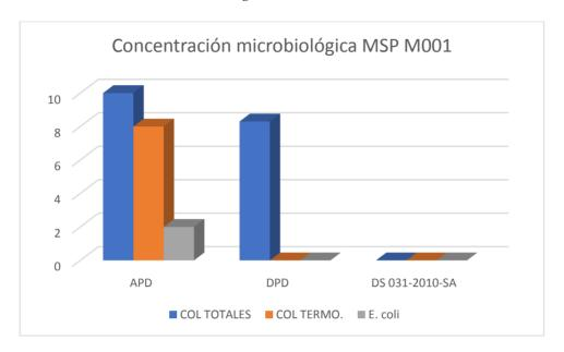
En la presente figura 1 se muestran los valores de la tabla N° 2 con el fin de mejorar su visualización e interpretación, evidenciándose que el proceso de desinfección solamente cumple con lo establecido en el DS 031-2010-SA, solamente para coliformes termotolerantes y E. coli, más no para coliformes totales, y esto es porque en las concentraciones de coliformes totales se consideran otros géneros de microorganismos.
