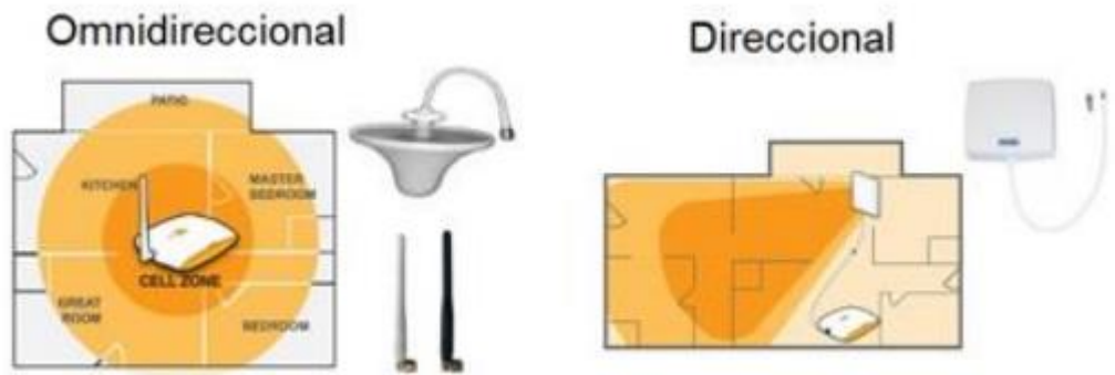
Figura 2. Antena omnidireccional y antena direccional
