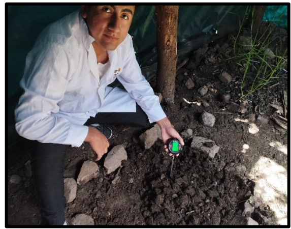
Foto N° 14: Medición de Temperatura y Humedad
