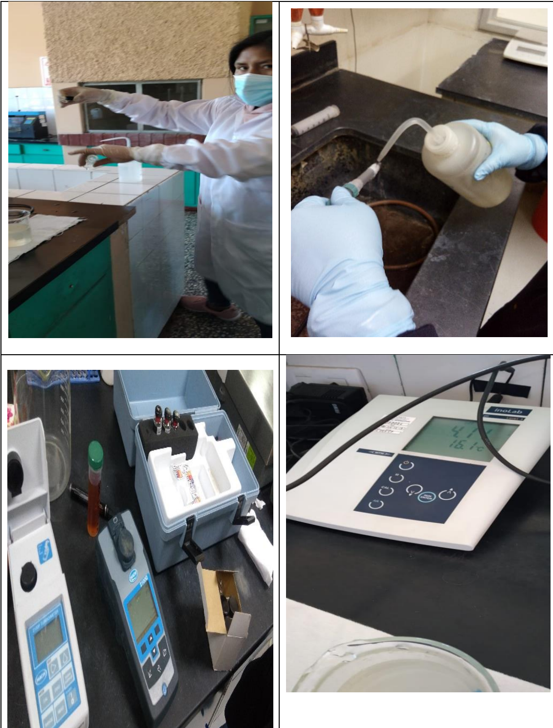
Fotografía 2. Calibración de Instrumentos: (pH metro, balanza electrónica y analítica; Oxímetro, Turbidímetro, Multiparámetro)
