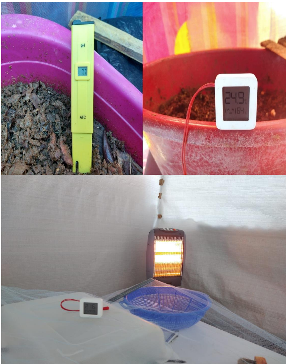
Fotografía 14: Control de parámetros ambientales y químicos: a) Medida del Ph en el ensayo b) higrómetro medida de temperatura y humedad relativa c) Calefactor-control de temperaturas bajas
