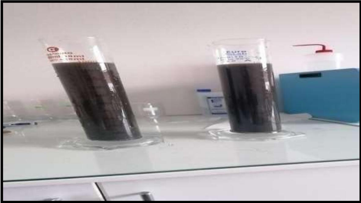
*Figura 18. Dejamos las probetas en reposo durante 30 minutos mientras el lodo sedimenta.*
