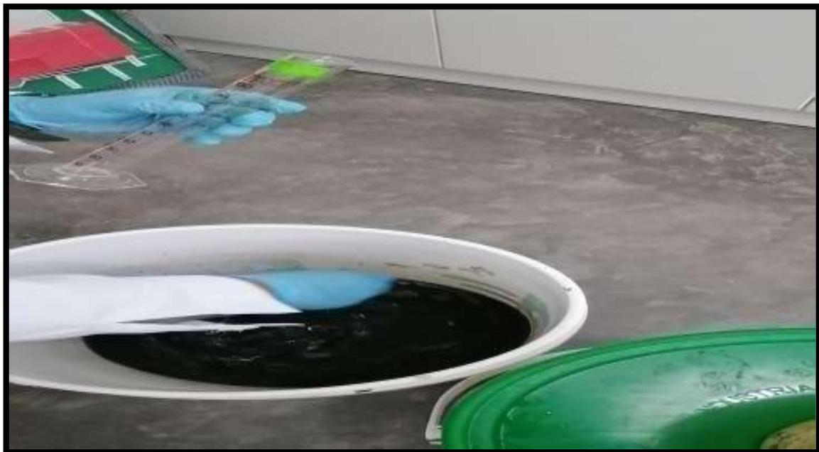
*Figura 17. Tesista realizando el procedimiento de llenado en la probeta del lodo que se quiere caracterizar y analizar.*
