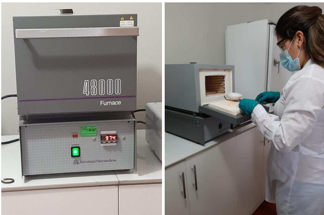
Figura 11: Calcinación del carbón antracita a una temperatura de 950 °C.
