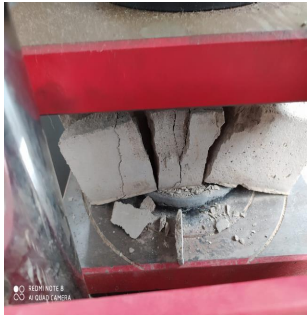
Figura 13: Ruptura del ladrillo por presión
