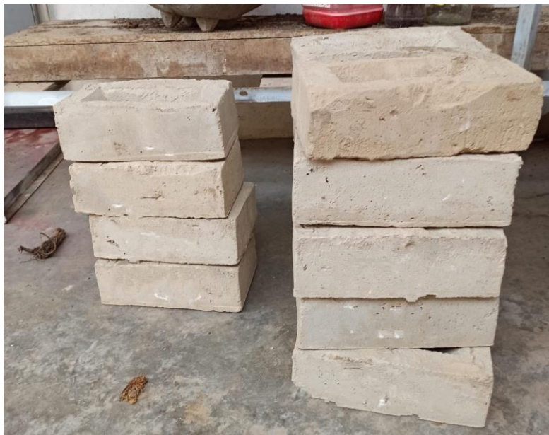
Figura 11: Ladrillos de 30 días de tiempo de curado
