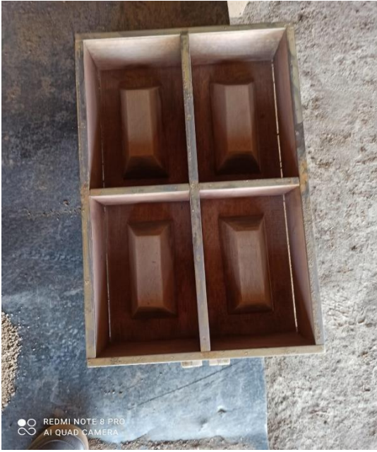
Figura 5: Molde para el ladrillo
