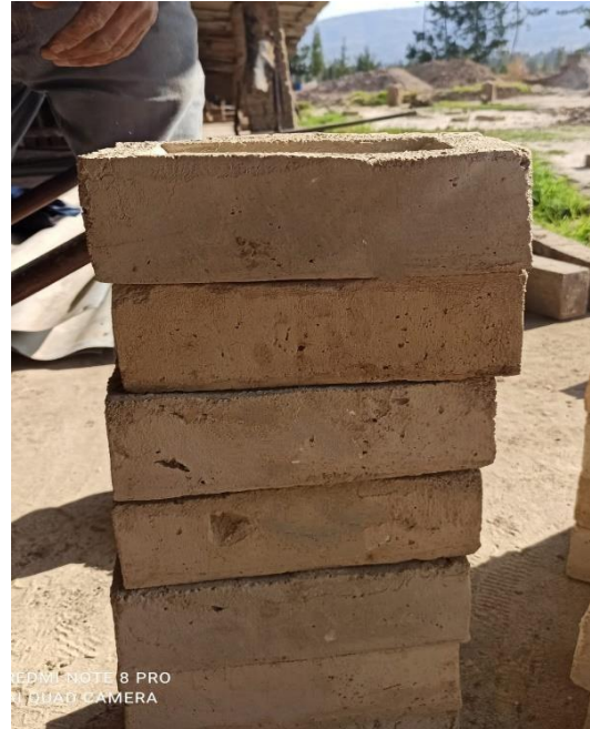
Figura 10: ladrillos de 20 días de tiempo de curado
