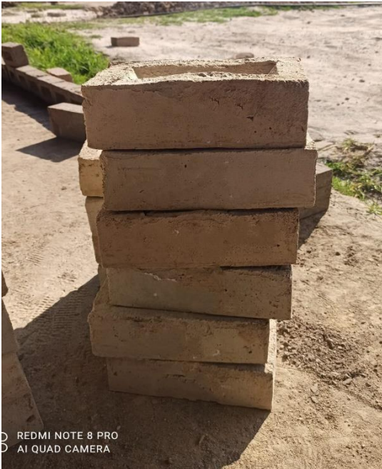
Figura 9: Ladrillos de 10 días de tiempo de curado
