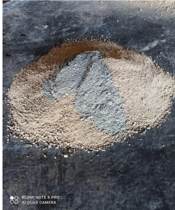
Figura 2: Relave y cemento
