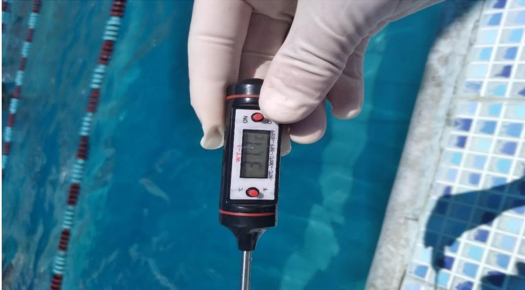
**Figura 5.** Medición de la temperatura in situ, utilizando un termómetro digital de campo.
