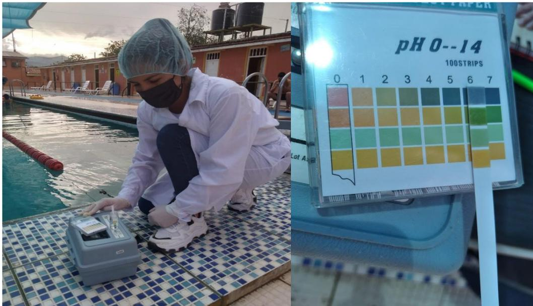
**Figura 6.** Medición del parámetro pH in situ, mediante cintas medidoras de pH.
