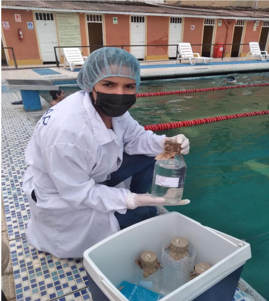
**Figura 7.** Conservación y transporte de muestras, dentro de un cooler y gel refrigerante
