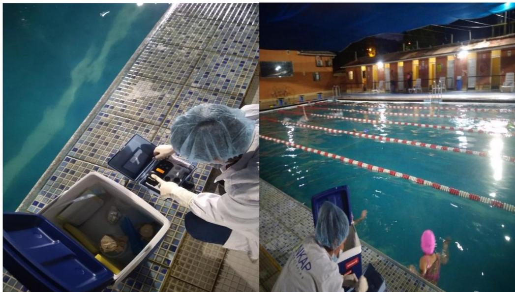
**Figura 4.** Medición in situ del parámetro fisicoquímico cloro residual, mediante el método colorimétrico, con fecha de 13 de marzo del 2021
