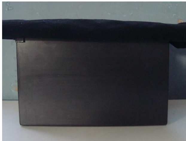
Foto 20. Almacenado de las muestras en el laboratorio de la UPAGU, a una temperatura ambiente de 21°, en un cajón oscuro sin contaminación de luz o aire.
