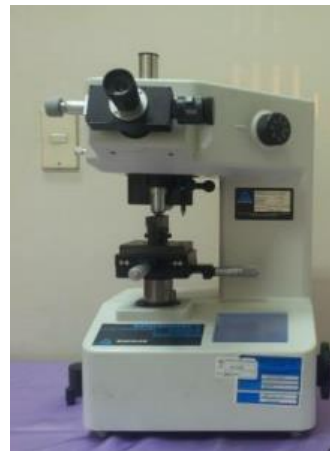
Foto 26, 27. Utilización del microdurómetro (Buehler, USA) perteneciente al laboratorio de la facultad de Ingeniería de la Universidad Privada del Norte (Sede Cajamarca), programado para aplicar cargas de 100g en un tiempo de 15 segundos.
