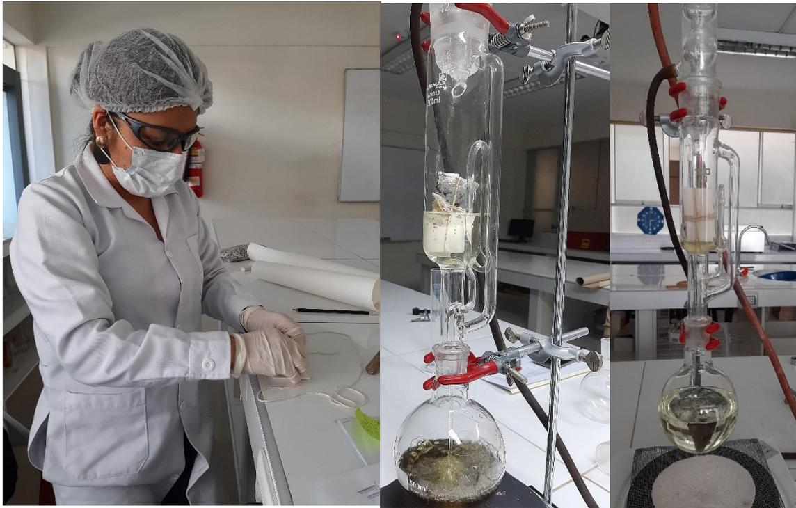
**Fotografía 07:** Extracción de la porción flavonoica en el equipo de soxhlet
