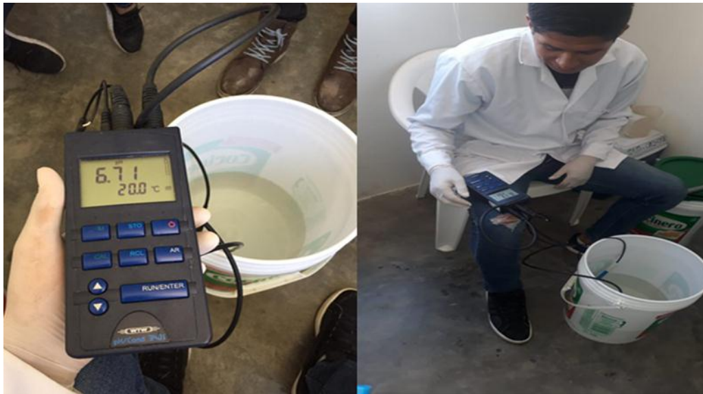
Figura 32: Tesistas midiendo temperatura, pH y conductividad eléctrica con el equipo Multiparametro
