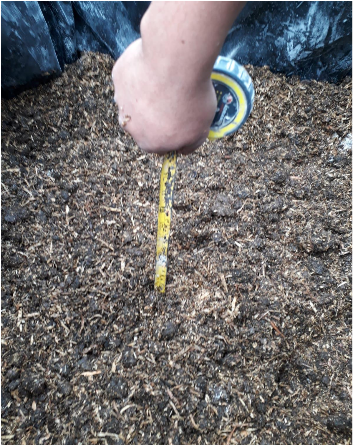
Foto N° 08 Capa de sustrato de 10 cm.
