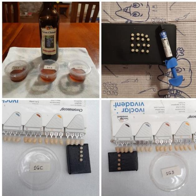
**Ilustración 13: toma de color de la resina Filtek Z350 sumergida en vino**
