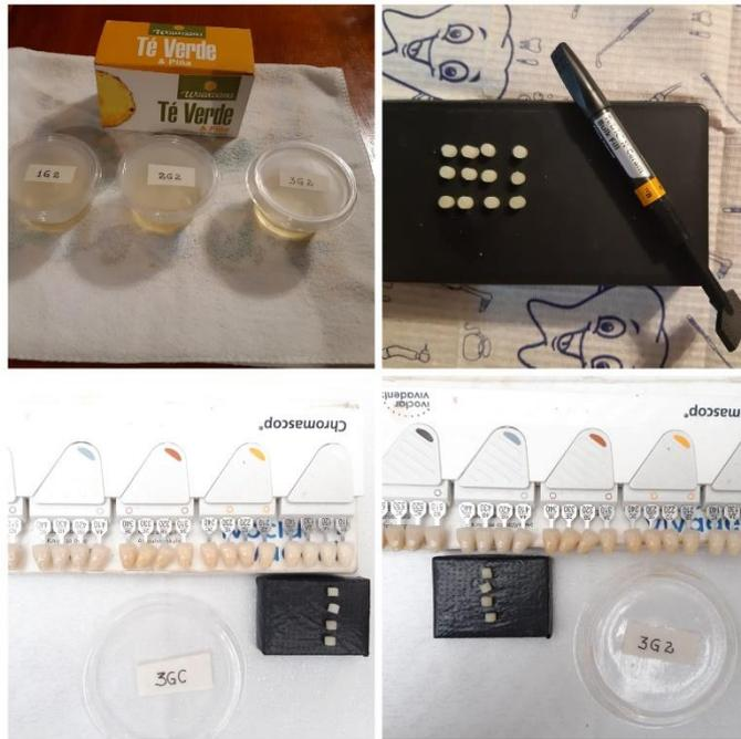
**Ilustración 18: toma de color de la resina Fill Tetric N-Ceram Bulk Fill sumergida en té verde**
