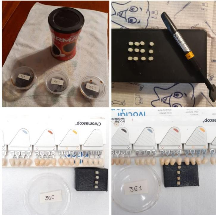
**Ilustración 17: toma de color de la resina Fill Tetric N-Ceram Bulk Fill sumergida en café**
