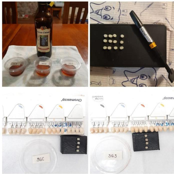
**Ilustración 19: toma de color de la resina Fill Tetric N-Ceram Bulk Fill sumergida en vino**
