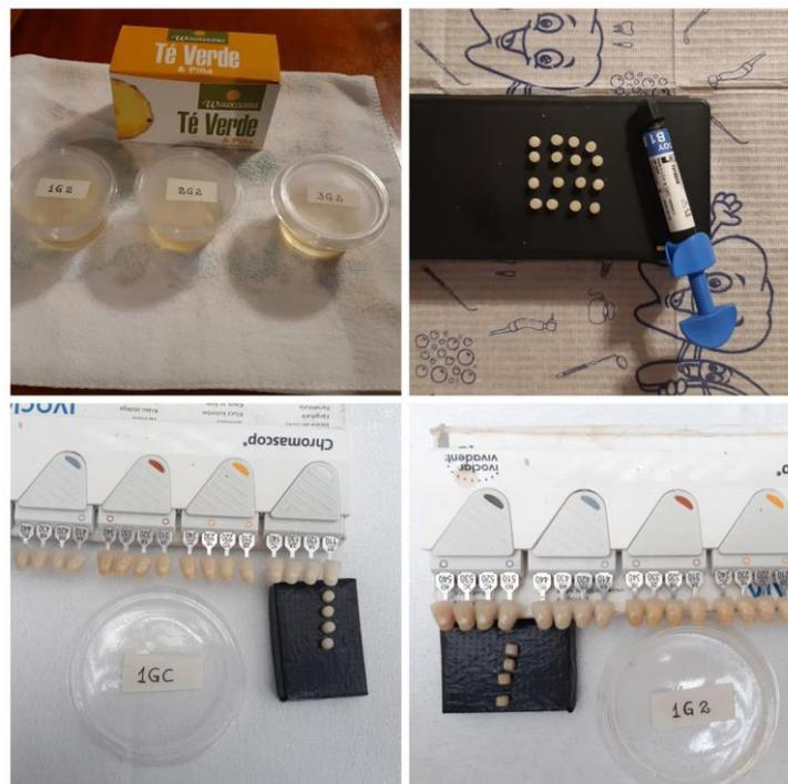
**Ilustración 12: toma de color de la resina Filtek Z350 sumergida en té verde**
