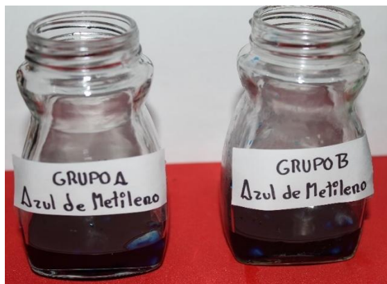
Imagen N° 19. Piezas puestas en azul de metileno por 24 horas
