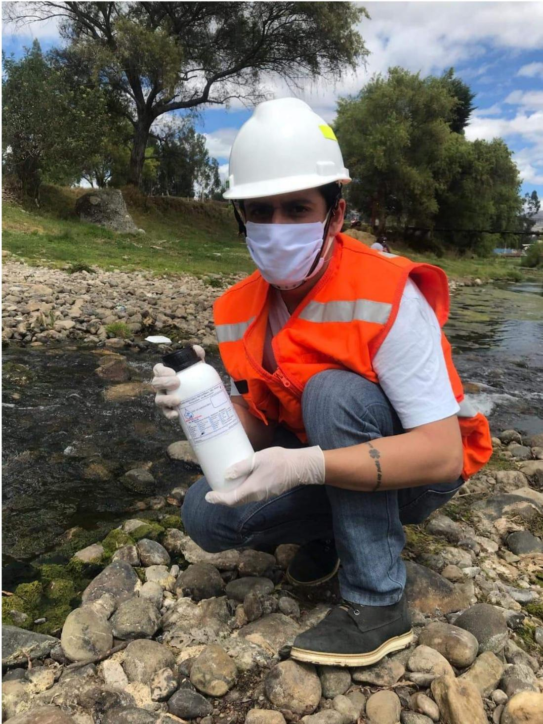
*Figura 7.* Toma de muestra - demanda bioquímica de oxígeno
