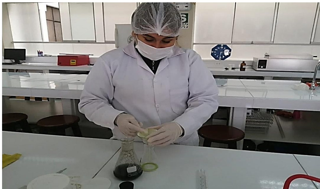
Fotografía 10. Filtrar el extracto alcohólico.
