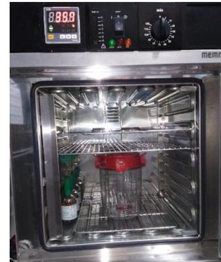
Figura 11 Incubación en condiciones de microaerofilia a  $36\text{ }^{\circ}\text{C} \pm 1\text{ }^{\circ}\text{C}$ , durante 24 horas
