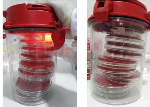
Figura 18 Placas invertidas en ambiente de microaerofilia para incubación a  $35\text{ }^{\circ}\text{C} \pm 1\text{ }^{\circ}\text{C}$  durante 24 horas (Incubadoras Memmert)
