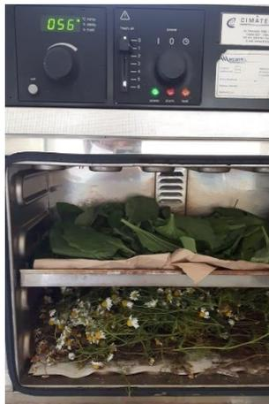
Figura 4 Secado de 500 g de cada planta, en estufa a 56° por 72 horas
