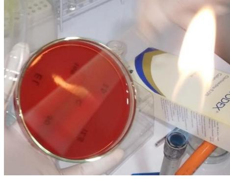
Figura 17 Inoculación de la superficie de las placas de Petri conteniendo agar sangre, por rayado con el hisopo en tres direcciones con rotaciones de 60° aproximadamente, y sobre los bordes del agar como paso final
