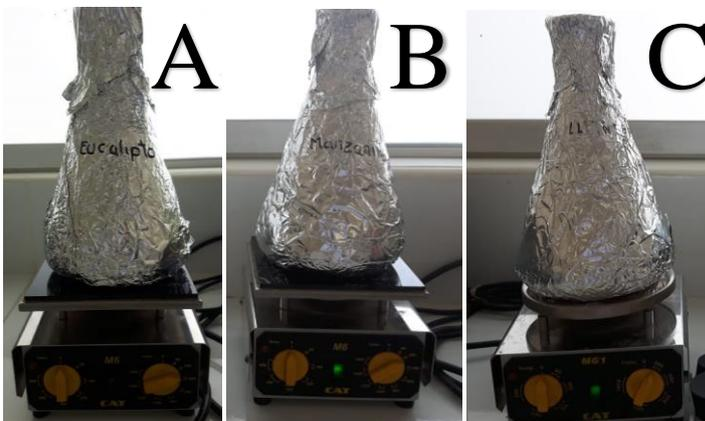
Figura 6 Método por agitación constante, 300 revoluciones/minuto por 24 horas
