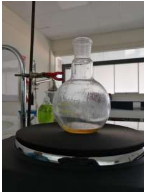
Figura 20. Separación del aceite del solvente por medio de evaporación
