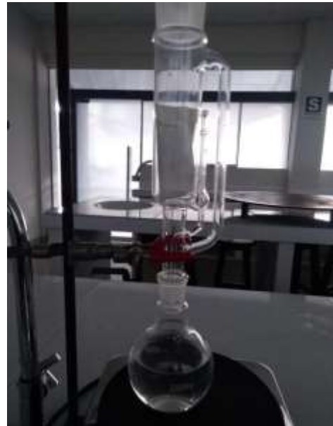
Figura 13. Equipo Soxhlet armado
