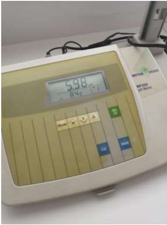
Figura 29. pH Muestra de aceite de palta (3h a 90 °C)
