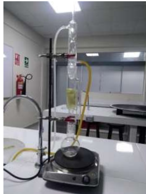
Figura 15. Equipo Soxhlet en funcionamiento
