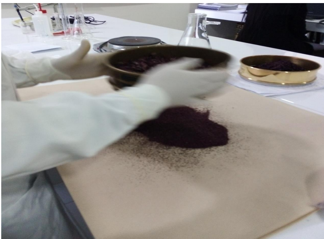
Fotografía N° 08: Tamizaje de la coronta del maíz morado en un tamiz número 100
