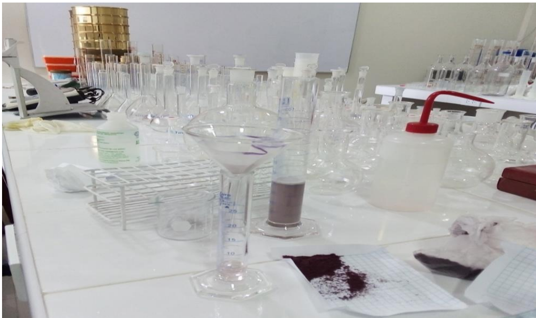
Fotografía N° 22: Determinación in vitro del factor de protección solar, Patrón factor 50 más muestra obtenida
