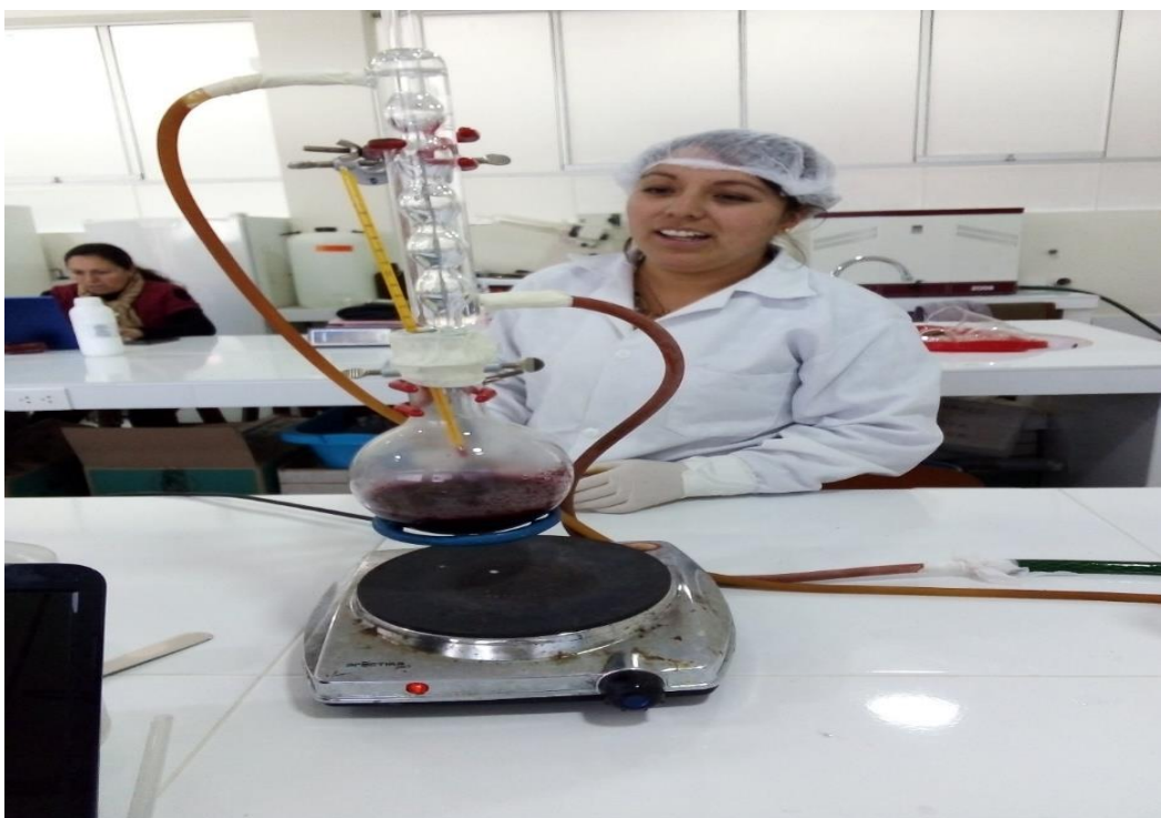
Fotografía N° 10. Armado del equipo para realizar el método de calentamiento para la extracción de antocianinas
