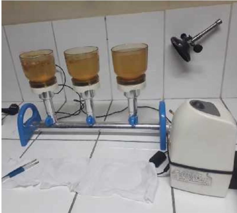
Figura 25: Muestra de agua en el equipo de filtración
