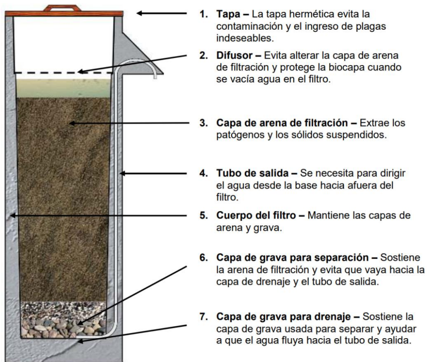
Figura 2: Componentes del filtro de Bioarena (CAWST,2009)
