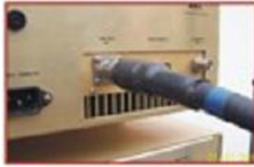
Figura 43: Salida de Cable de RF hacia las antenas de TV.
