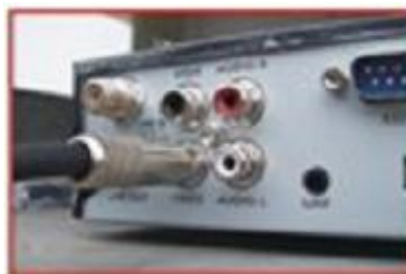
Figura 46: Salida de Cable de Video del receptor satelital al Transmisor de TV.
