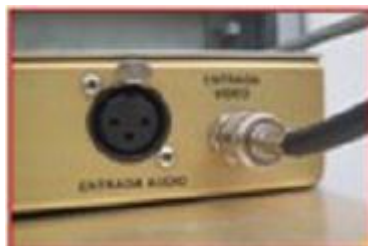
Figura 47: Entrada del Cable de Video al Transmisor de TV.
