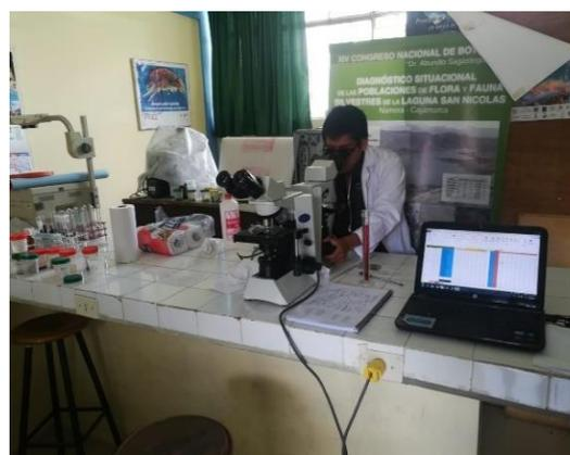
Figura 39. Identificación las muestras en 1mm<sup>2</sup> con la cámara Gridder Sedgewick Rafter para la muestra de arena en el laboratorio de Ecología de la Universidad Nacional de Cajamarca
