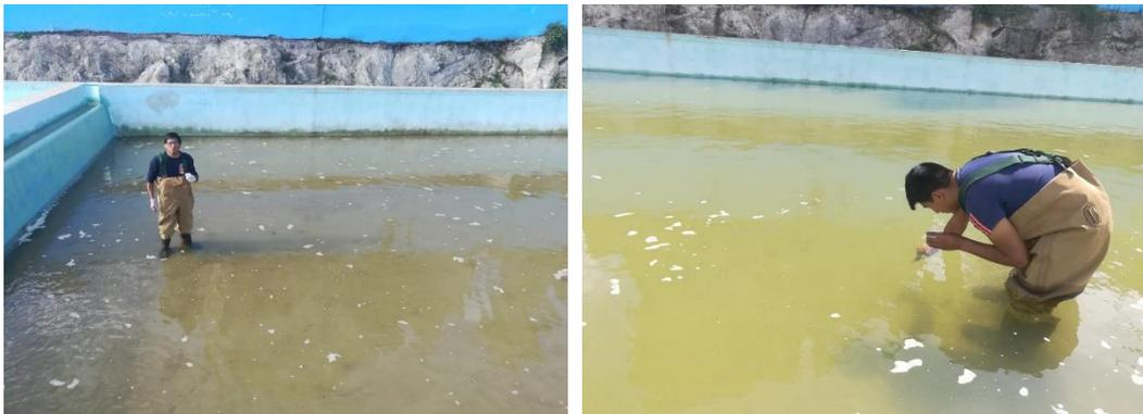
Figura 35. Colecta de la muestra de sustrato de arena y de sustrato de tecnopor en los filtros lentos
