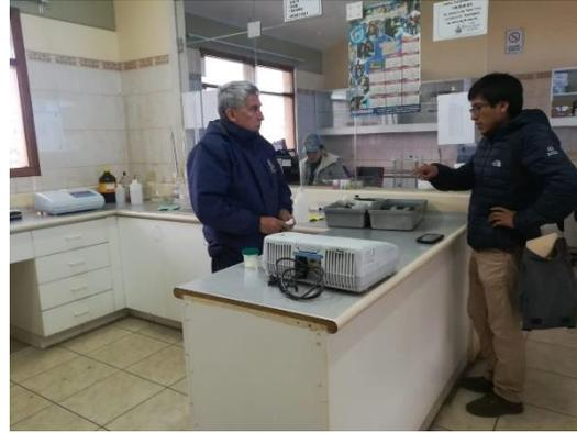
Figura 37. Medición del pH y la turbiedad en el laboratorio de la EPS de Sedacaj SA – Santa Apolonia
