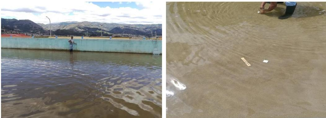
Figura 36. Medición del tirante de agua y de la temperatura del agua en los filtros lentos
