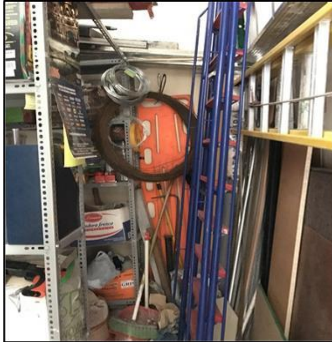
FOTO N°03. Escaleras de aluminio como de metal obstruyendo el paso peatonal y camilla totalmente obstruida para su acceso en caso de emergencia.
