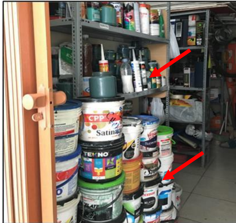
FOTO N°01. Se observa en la imagen que la empresa no tiene un correcto orden de almacenamiento de líquidos inflamables.
