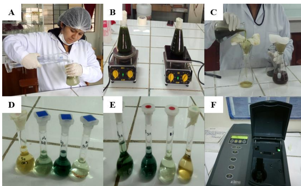
Fotografía N° 08: Cuantificación de taninos. A: Muestras secas con 500 mL de etanol. B: Agitación constante de las muestras a temperatura ambiente, durante 24 horas. C: Filtrado de las muestras de los extractos hidroalcohólicos. D: Soluciones para lectura de Sonchus oleraceus L “cerraja”: E: Soluciones para lectura de Solanum nigrum L “hierba mora” .I: Lectura en el espectrofotómetro.
